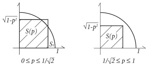
まず  $0 \leq p \leq \frac{1}{\sqrt{2}}$  での切り口の面積  $S(p)$  を求めると、図の  $S_1$  部分の面積は扇形から 3 角形を引いたもの :
